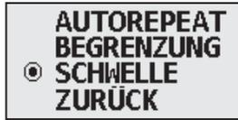
Legen Sie durch Betätigen der Auswahlstasten „+“ und „-“ die maximale Stromintensität („SCHWELLE“) in Milliampere (mA) fest und bestätigen Sie die Auswahl durch Drücken der „OK“-Taste (Werkseitig ist eine maximale Stromintensität von 15 mA voreingestellt).
