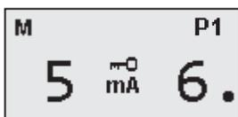
Wenn 8 Sekunden keine Eingabe erfolgt, dann wird die Stromeinstellung verriegelt. Diesen Vorgang symbolisiert ein kleiner Schlüssel. Sie können die Stromstärke daraufhin nur noch reduzieren. Um sie zu erhöhen muss zunächst die „-“-Taste und anschließend die „+“-Taste betätigt werden.
