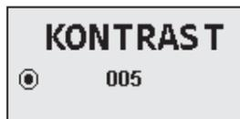
Standardmäßig ist der Kontrast des Displays auf 0% Kontrasterhöhung eingestellt. Dieser Wert ist für die OLED-Anzeige optimal. Die Einstellung sollte nicht verändert werden. Höhere Kontrasteinstellungen können zur vorzeitigen Alterung des Displays oder zum Totalausfall der Anzeige führen.
