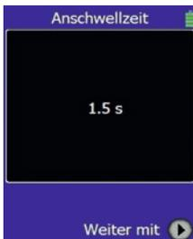
Um Zeit zu vergrößern mit dem Drehschalter im Uhrzeigersinn drehen, sonst entgegen.
