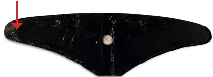
Elektrode mit zu wenig Gel
